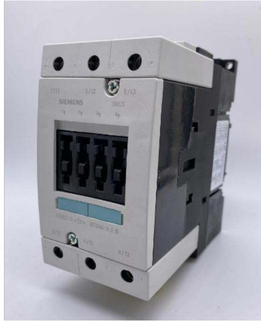
接触器的选用应按满足被控制设备的要求进行，除额定工作电压应与被控设备的额定电压相同外，被控设备的负载功率、使用类别、操作频率、工作寿命、安装方式及尺寸以及经济性等是选择的依据。接触器的串并联使用：有许多用电设备是单相负载，因此，可将多极接触器的几个极并联使用。如电阻炉、电焊变压器等。当用几个极并联起来使用时，可以选用较小容量的接触器。但必须注意，并联后接触器的约定发热电流并不完全与并联的极数成正比。这是由于积极动、静触头回路的电阻值不一定完全相等，以致使流过积极的电流不是平均分配。所以，两极并联后电流只可增加到1.8倍，三极并联后，电流只可增加到2~2.4倍。另外，需要指出，由于并联后的各极触头不可能同时接通和断开，因此，不能提高接通和分断能力。接触器是利用线圈来控制电路的通断，接触器通电后，常开的就闭上了，常闭的打开，这样来控制。黄浦区订做接触器费用是多少
