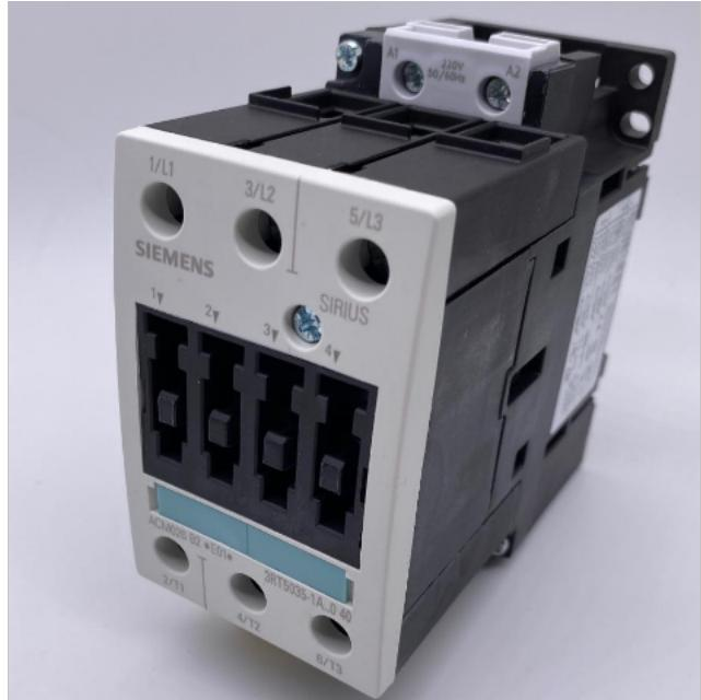
绕线式感应电动机AC<sub>0</sub>2使用类别用接触器的选用。此类负载下接触器的接通电流与分断电流均为2.5倍电动机的额定电流Ie即AC<sub>0</sub>2使用类别，一般选用转动式交流接触器较合适。因为其电寿命比直动式的高，而且便于维修。选用时可按电动机额定电流查表即可。（注意：每小时操作循环次数较高的场合，不宜选用CJ12B<sub>0</sub>也可选用直动式交流接触器，但其电寿命不如转动式AC<sub>0</sub>3电寿命为120万的直动式接触器，在AC<sub>0</sub>2使用，其电寿命约为十万次左右。主要结构交流接触器利用主接点来开闭电路，接触器用辅助接点来导通控制回路。主接点一般是常开接点，而辅助接点常有两对常开接点和常闭接点，小型的接触器也经常作为中间继电器配合主电路使用。
