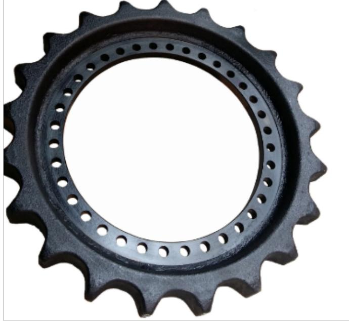
“四轮一带”中的四轮指的是驱动轮，导向轮，支重轮，托轮，一带指的是履带。直接关系到挖掘机的工作性能和行走性能，其重量及制造成本占到了挖掘机制造成本的四分之一。履带：分类有整体式和组合式两种。整体式履带是履带板上带啮合齿，与驱动轮啮合，履带板本身成为支重轮等轮子的滚动轨道。驱动轮：液压挖掘机发动机的动力通过行走马达和驱动轮传给履带，要求驱动轮与履带的轨链啮合正确，传动平稳，并且当履带因销套磨损而伸长时仍能很好的啮合。支重轮：支重轮的作用是将挖掘机重量传给地面，挖掘机在不平的路面上行驶时支重轮会受地面冲击力，因此支重轮所受载荷大，工作条件恶劣，经常处于尘土中，有时还浸泡在泥水中，所以要求有良好的密封。导向轮：导向轮用来引导履带正确绕转，防止其跑偏和越轨。多数的挖掘机也同时起到了支重轮的作用。这样可以增加履带对地面的接触面积，减小接地比压。托轮：作用是向上托住履带，使履带有一定的张紧度。
