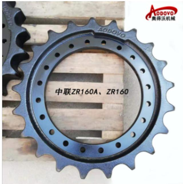
四轮一带相关的维护保养方法：履带履带主要由履带板和链轨节组成，履带板分为标准板和加长板。标准板用于土方工况，加长板用于湿地工况。矿山上对履带板的磨损严重，行走时碎石有时会卡在两块板之间的缝隙中，当转至与地面接触时就会对两块板产生挤压，履带板就容易发生弯曲变形，长时间行走也会使履带板螺栓固定处出现开裂问题。链轨节是与驱动齿圈接触由齿圈带动进行旋转。履带涨紧度过紧会造成链轨节、齿圈和引导轮早期磨损。所以根据施工路况不同，需要调节履带张紧度。中联ZR220旋挖钻机驱动轮。中联ZR220旋挖钻机驱动轮批发
